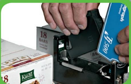
Para cambiar el cartucho de la tinta solo abra la cubierta metálica y cambielo por uno nuevo
