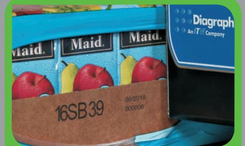
Imprime mensajes de 1 y 2 líneas de 1/4" ó 1/2" de alto sobre sus productos ó empaques (hasta 5 líneas usando Arial 30)
